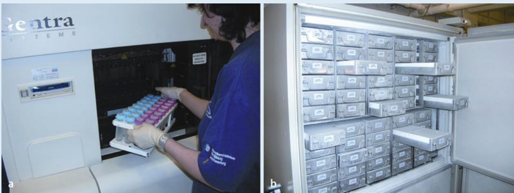
Abb. 2 ◀ DNA-Extraktion und Lagerung. a Zur Extraktion der Lymphozyten-DNA wird ein Extraktionsroboter eingesetzt. b Aliquots der Plasma- und Serumproben werden bei -80^{\circ}\text{C} gelagert
